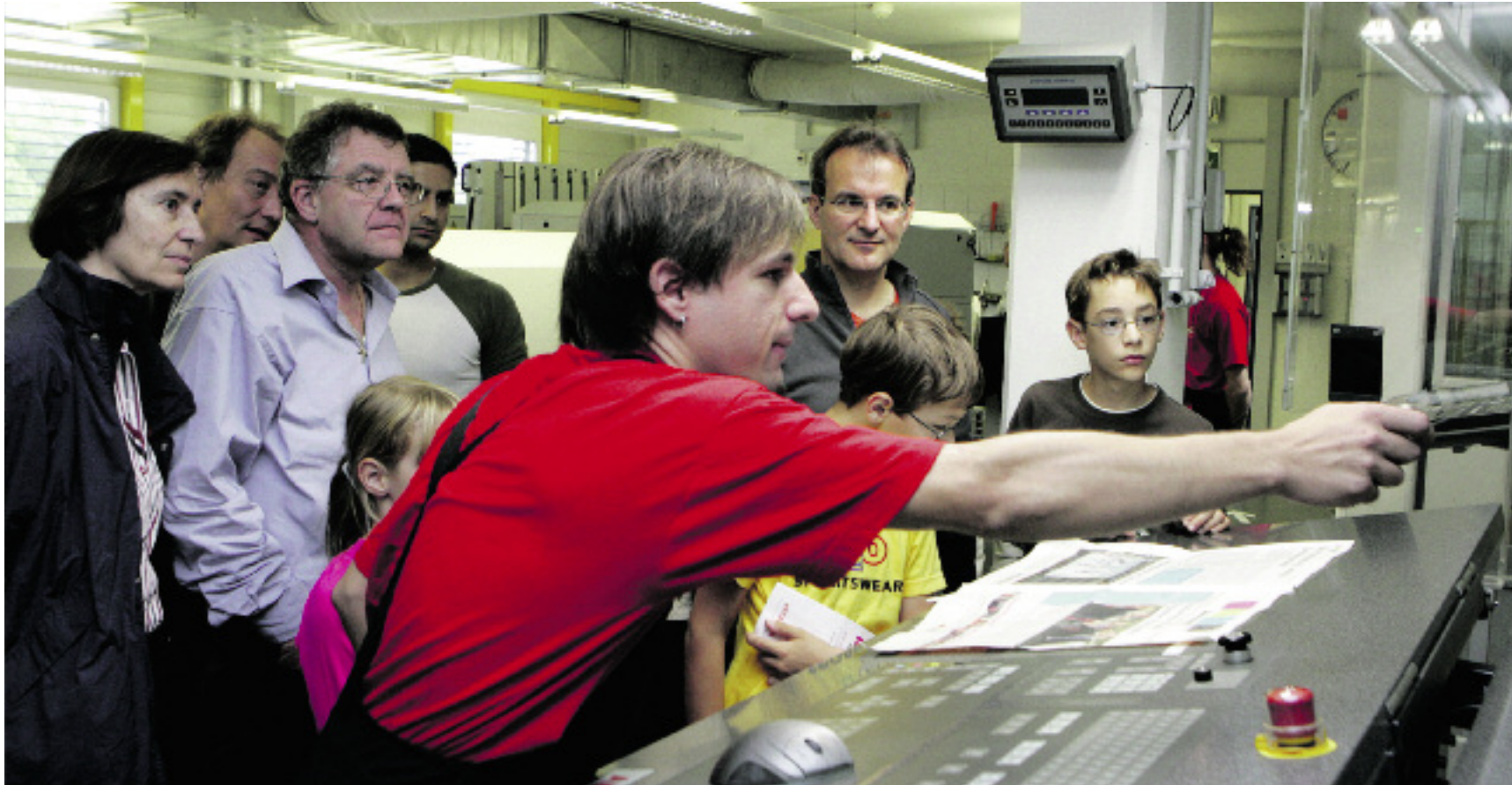
Elektronischer Leitstand: Passer und Farben werden eingestellt und justiert.
